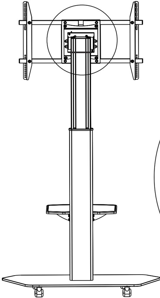
Die TV-Halterung kann um 90° gedreht werden, wenn die Inbusschrauben-gemäß der Markierung auf der Abbildung-gelöst werden.
