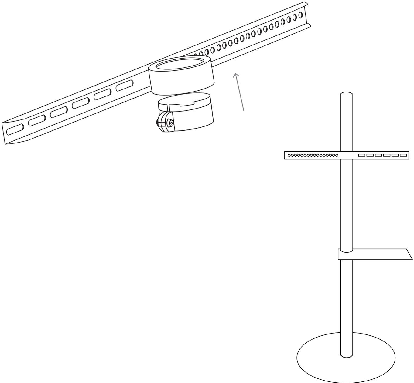
Die untere TV-Schiene besteht aus zwei Teilen. Bitte montieren Sie sie wie folgt:
