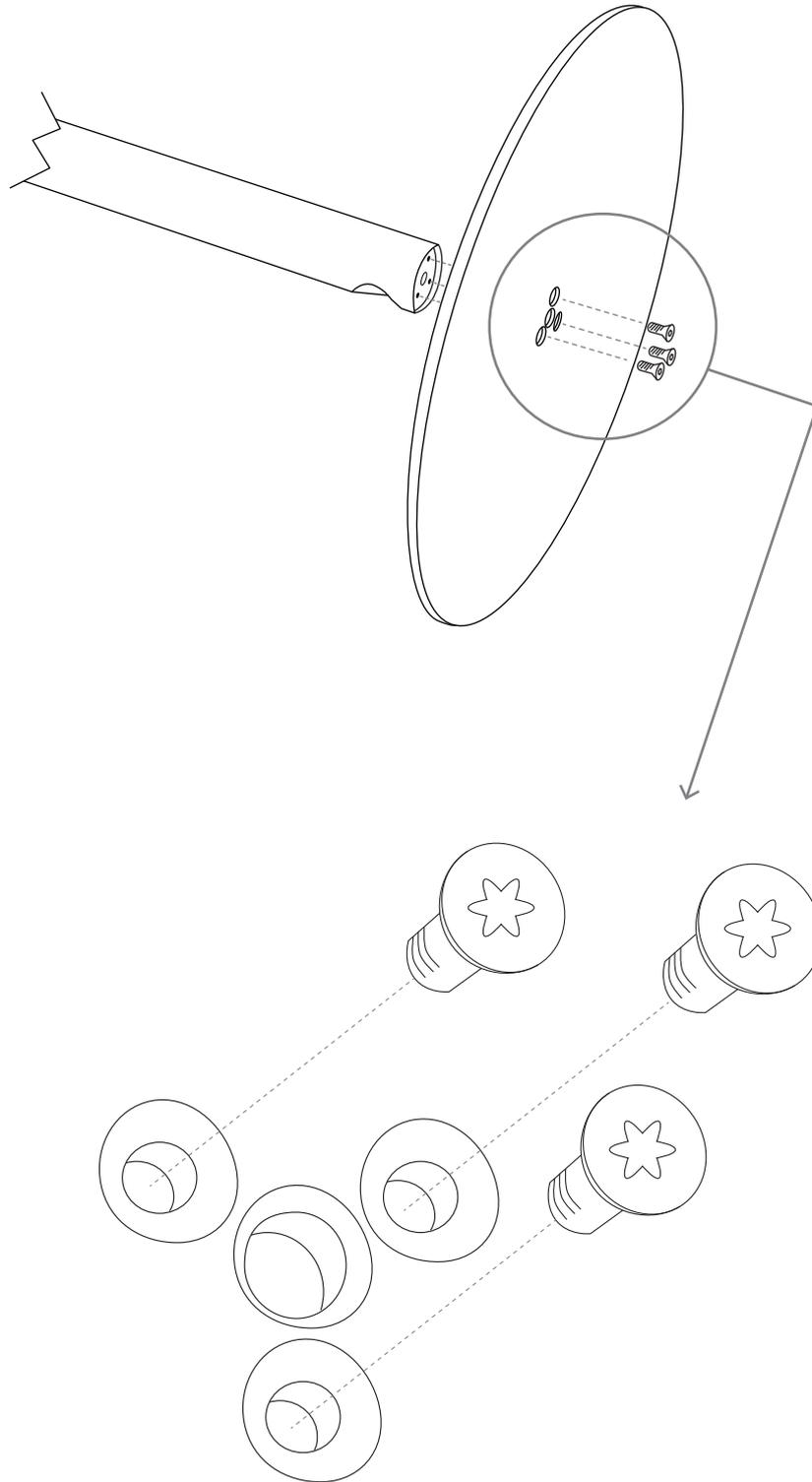
Verbinden Sie die runde Bodenplatte mit der Standsäule. Verwenden Sie drei M8X20mm-Schrauben. Sie finden diese im Zubehörbeutel der Kammer 11.
