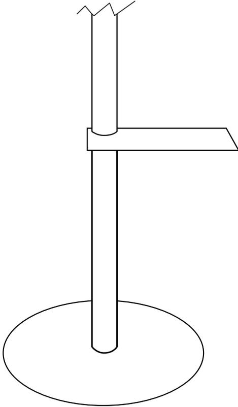
Schieben Sie die AV-Ablage in die gewünschte Position und fixieren Sie die Position indem Sie den Kunststoffgriff festziehen.
