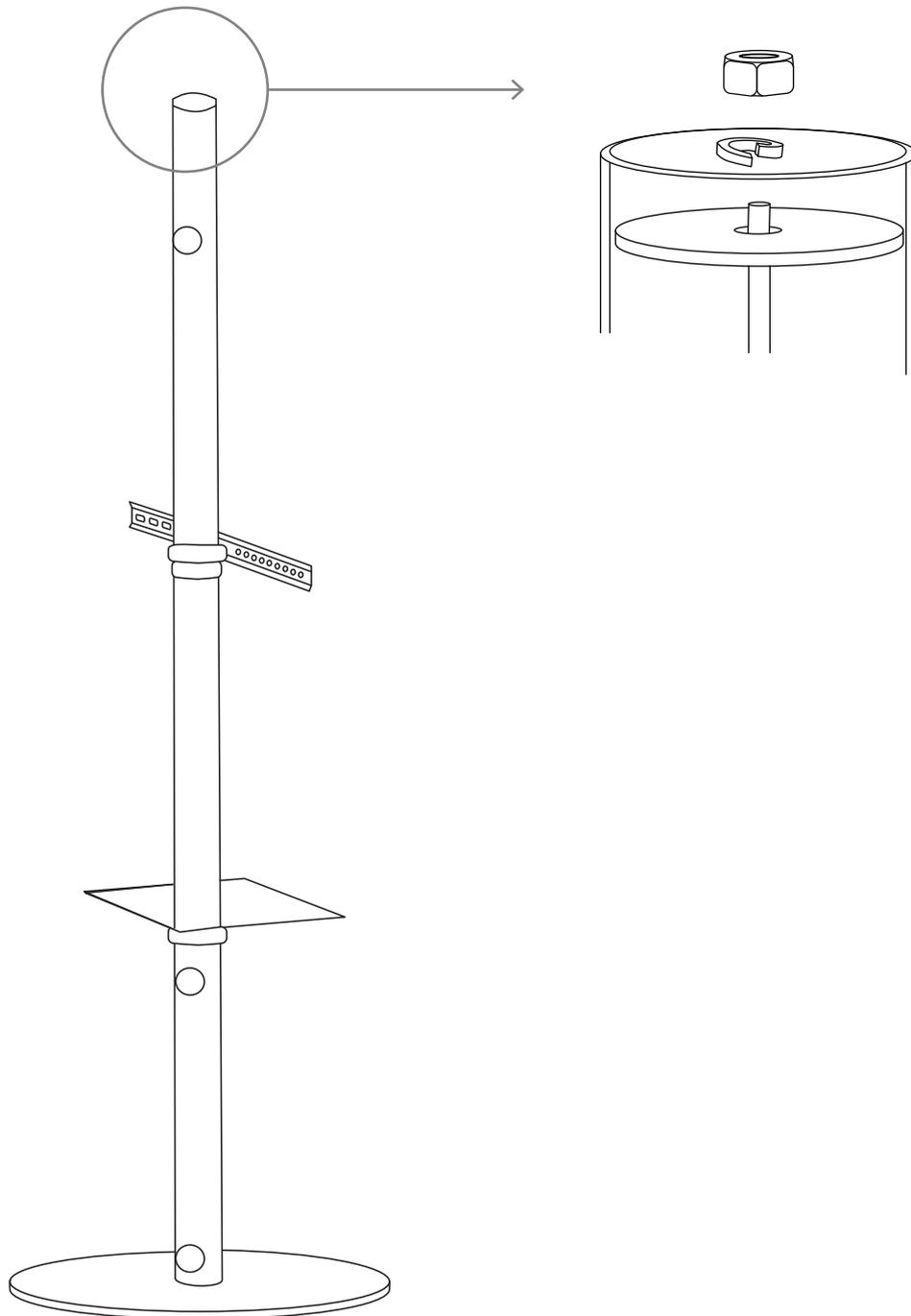
Führen Sie die Gewindestange, ausgehend vom mittleren Bohrloch, durch die Säule. Schrauben Sie sie dann mittels der Gewindestange in die Oberseite der Säule. Verwenden Sie Federscheibe und Mutter und ziehen Sie diese fest. Federscheibe und Mutter befinden sich in Kammer 12 im Zubehörbeutel.
