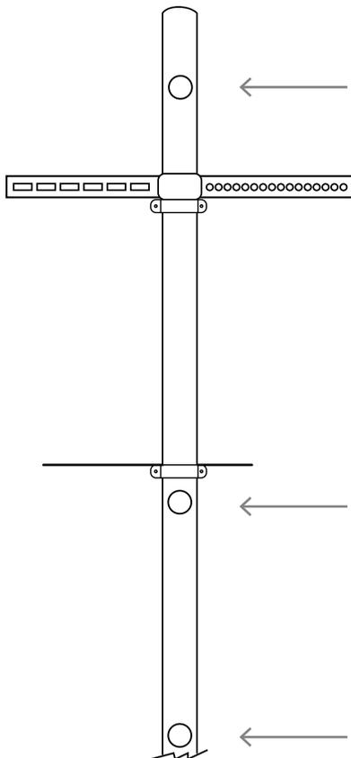
Schieben Sie die Kabel durch die passenden Zugangsöffnungen und verlegen Sie die Kabel geschützt innerhalb der Standsäule.
