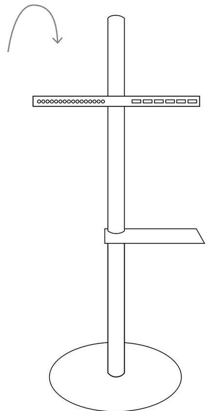
Montieren Sie die obere TV-Schiene rückseitig am Bildschirm. Schieben Sie die Aufnahme von oben auf die Standsäule. Bitte nicht verkanten. Schrauben Sie beide Schienen fest.
